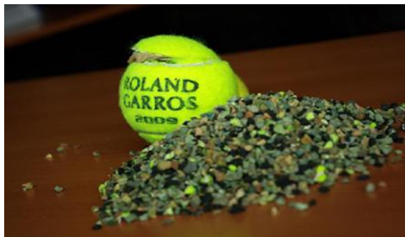
Granulat produit à l'issue du recyclage de balles de tennis
